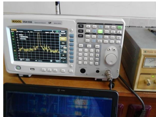
Gambar 11. Pengukuran Transmit pada Frekuensi 7,035 MHz
