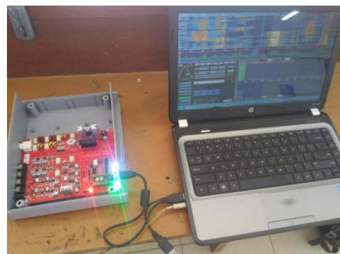
Gambar 7. Pengujian Sistem SDR
