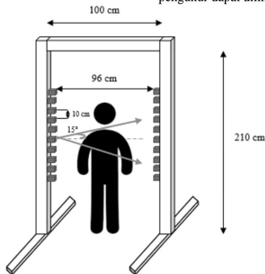
Gambar 1. Rancangan Alat Pengukur
