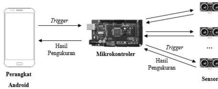
Gambar 2. Mekanisme Pengiriman Data
