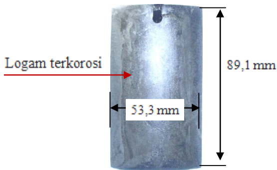
Gambar 2. Korosi yang terjadi pada hari ke 36 berwarna kecoklatan.
