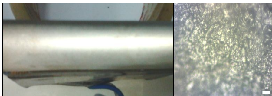
Gambar 4. Foto makrostruktur uji adhesivitas lapisan krom
