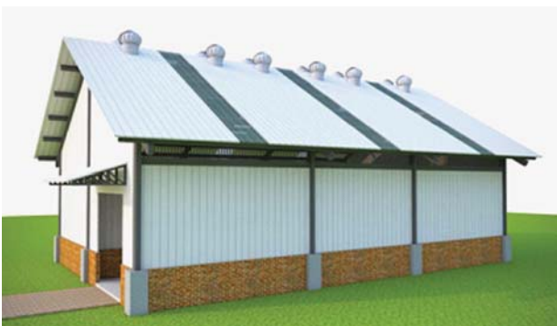
Gambar 11 Ruang Produksi dengan Turbin Ventilator
