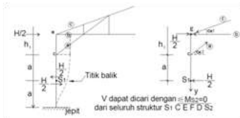
Gambar 8 Kuda-kuda dengan perletakan bawah kolom sendi
