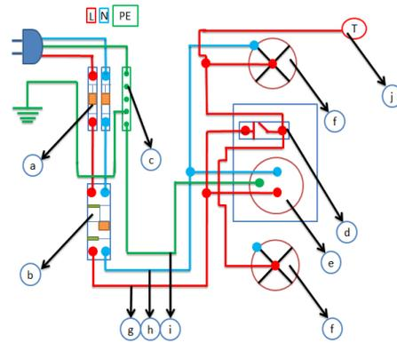
Gambar 4. Simulasi Pengawatan Instalasi Rumah Prototipe ELCB
