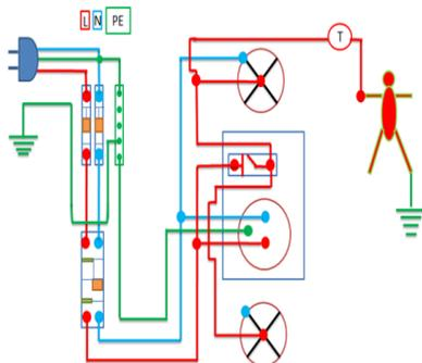
Gambar 6. Pengawatan Arus Bocor Pada Fasa (L-PE)
