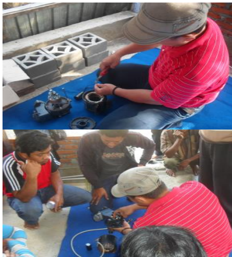
Gambar 8. Memasukkan Rotor dan mewiring
