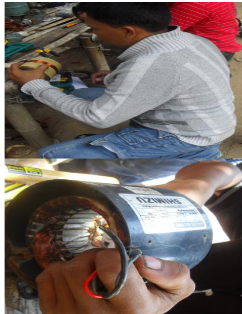
Gambar 7. Menggulung dan memasukkan belitan ke Stator
