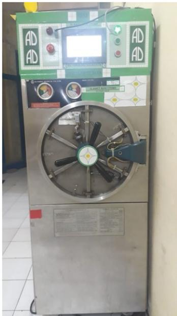
Gambar 18. Hasil penempatan door lock pada pintu autoclave
