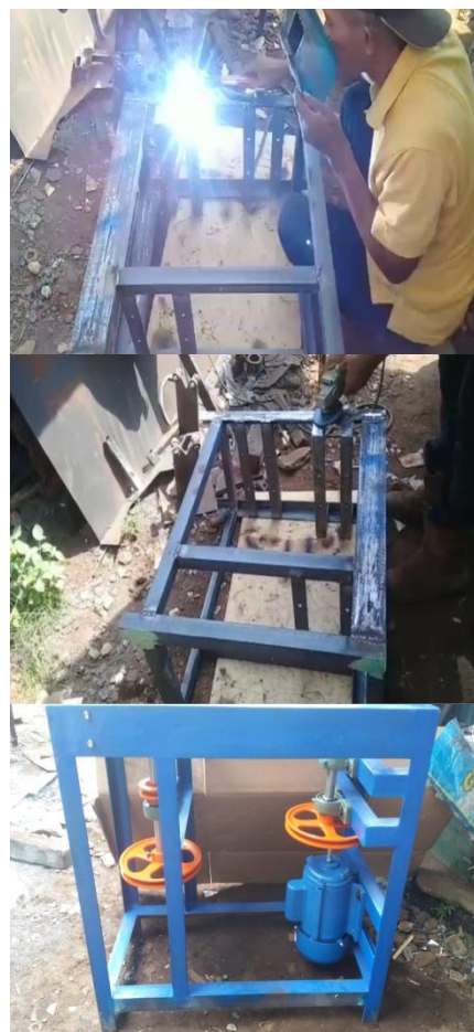
Gambar 5. proses pembuatan mesin perajang singkong
