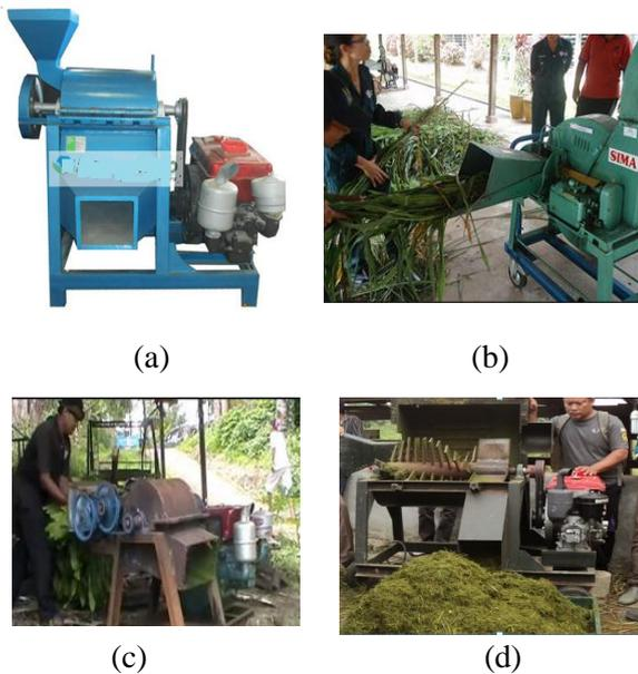
Gambar 1. (a), (b), (c), dan (d), Mesin Pencacah Pakan Ternak Sapi
