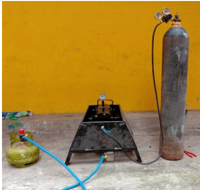
Gambar 3. 3. Rangkaiandapurpirolisis yang telahdibuat
