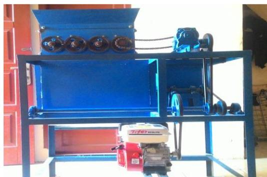
Gambar .10. Mesin Pengupas Kulit Kacang Merah
