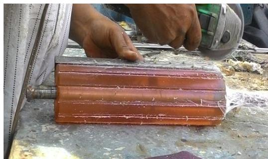
Gambar .7. proses pembuatan roll pengupas
