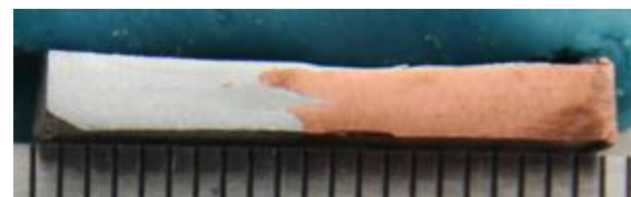
Gambar 3. Makrostruktur benda uji N = 800 RPM dan v = 16 mm/min
