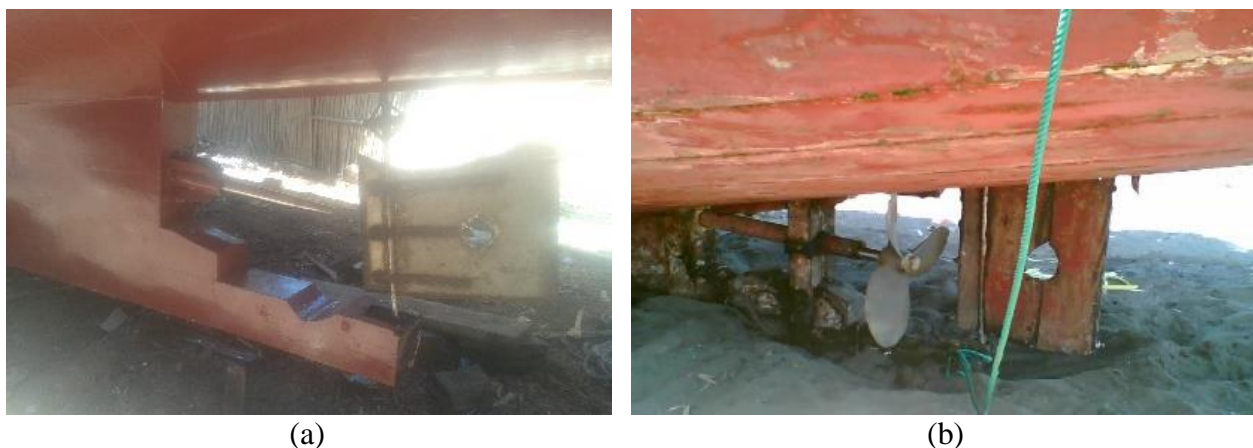
Gambar 2. Peletakan dan Desain Daun Kemudi Sejumlah Kapal Kayu Tradisional di Kabupaten Majene (a) dan Takalar (b).
