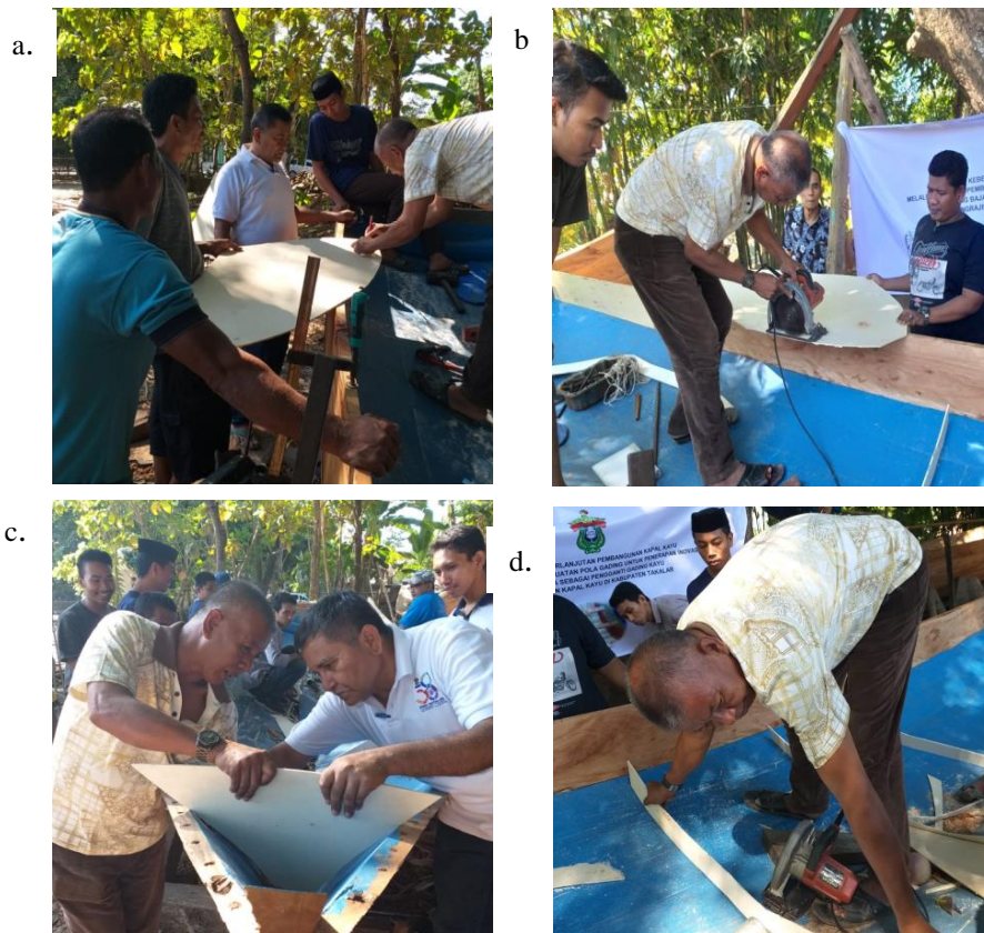
Gambar 4. Pemaparan teori pembuatan pola gading baja oleh tim pengabdian
