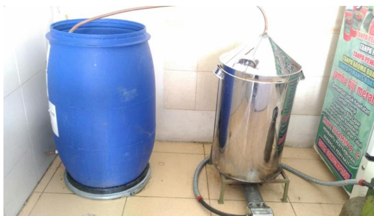
Gambar 1. Alat penyulingan minyak atsiri hasil penelitian
