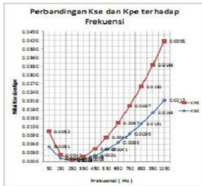
Gambar 4 : Pengaruh Frekuensi Harmonisa terhadap efek kulit ( KSE) dan efek kedekatan ( KPE)
