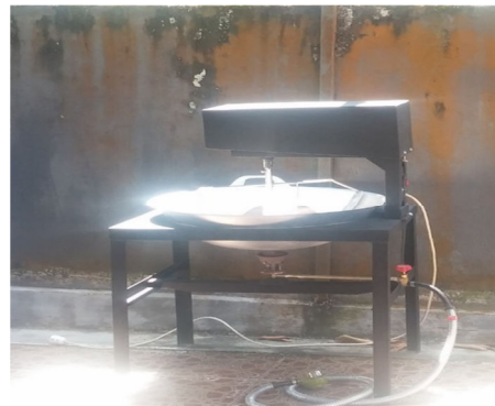
Gambar 6. Mesin Pembuat Sambal Dengan Kapasitas 10 kg
