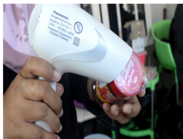
Gambar 19. Proses Pengemasan Dengan Menggunakan Plastik Shrink Dibantu Dengan Mesin Hairdryer
