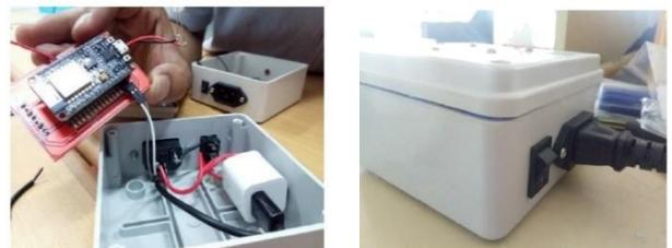
Gambar 4 Mesin kehadiran berbasis RFID yang telah berhasil dirakit
