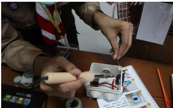
Untuk menghemat waktu, panitia sudah menyelesaikan beberapa step, yakni pemasangan konektor AC dan *header* serta *housing* sudah disolder. Karena komponennya berukuran kecil sehingga akan memakan waktu lama apabila terdapat diantara peserta belum pernah melakukan aktivitas *soldering*. Adapun kegiatan praktikum ini adalah sebagai berikut:
