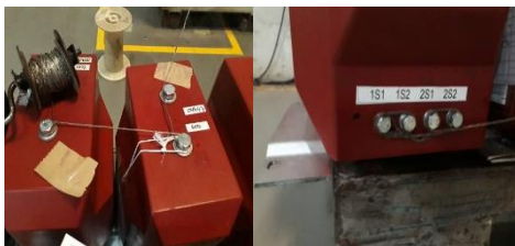
Gambar 9. Pengujian Applied pada Sisi Primer
