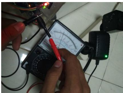
Gambar 4.1. Pengukuran tegangan output DC Sumber : Dokumentasi Penulis (2019)
