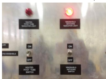
Gambar 3.1 Kondisi Saat Ini Aircraft Anti-icing pada Windshield Sumber : Dokumentasi Penulis (2018)
