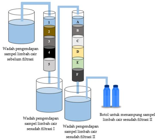
**Gambar 1.** Rangkaian Proses Filtrasi Sederhana Limbah Cair Laundry
