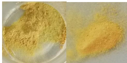
Gambar 7. Nanomaterial (left) MCM-41 dan (right) IBN yang sudah di-loading ekstrak kulit jeruk purut
