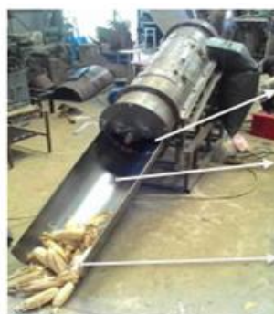
Gambar 6. Set Up Pengujian Unit Perontok Jagung
