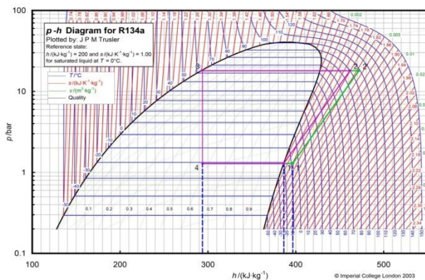
Gambar 11. Siklus p-h diagram AC setelah ditambah alat penukar kalor
