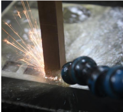
Gambar 5. Proses discharge pada mesin EDM.
