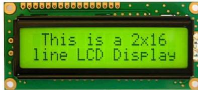
Gambar 7. Bentuk Fisik LCD 16 x 2
