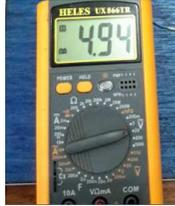
Gambar 18. Hasil pengukuran tegangan input sensor ultrasonik (ping)
