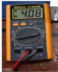
Gambar 17. Hasil pengukuran tegangan output Dioda
