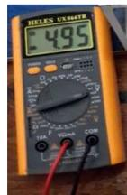
Gambar 15. Hasil pengukuran tegangan output IC Regulator LM7805
