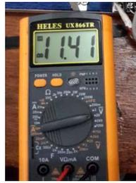
Gambar 13. Hasil pengukuran Tegangan output power supply
