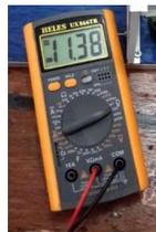
Gambar 14. Hasil pengukuran tegangan input IC Regulator LM7805
