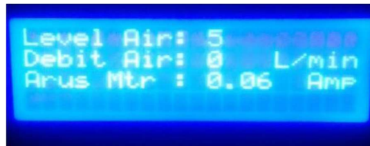
Gambar 19. Tampilan Level Air Pada LCD
