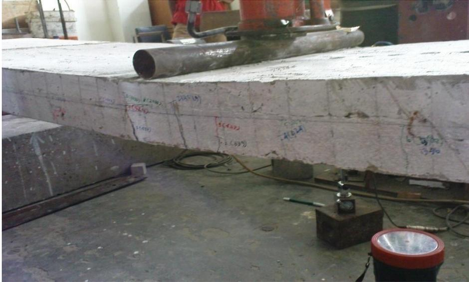
**Gambar 21.** Pola retak hasil pengujian pelat
