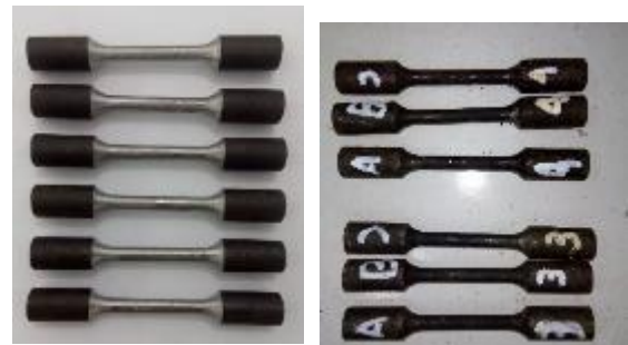
Gambar 6. Specimen uji sebelum quenching (kiri) dan setelah quenching (kanan).
