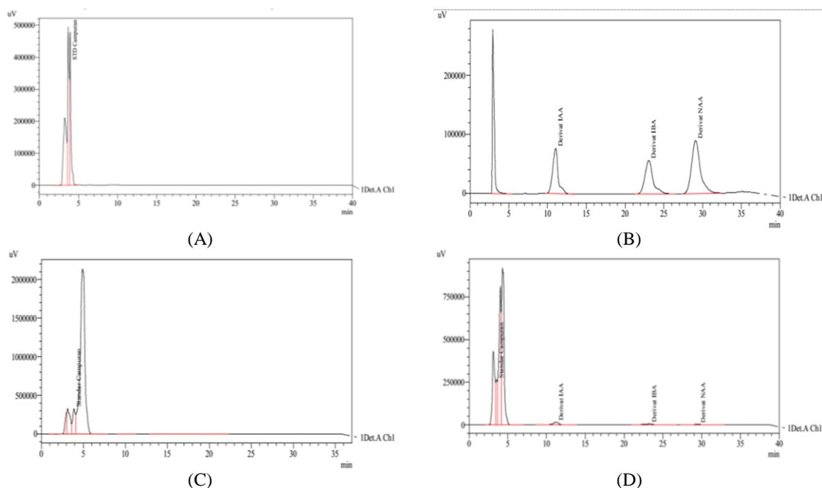
**Gambar 3.** Kromatogram standar campuran IAA, IBA dan NAA hasil derivatisasi. (A) derivatisasi dengan HMDS, (B) derivatisasi dengan TMCS, (C) derivatisasi dengan dengan MSTFA dan (D) derivatisasi dengan BSTFA.
