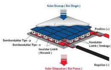
Gambar 1. Skema elemen Peltier
