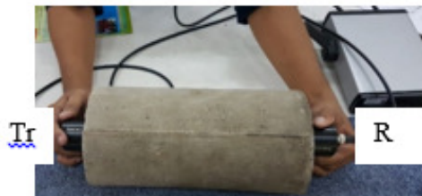
Gambar 1 Cara pengukuran dengan UPV (langsung)
