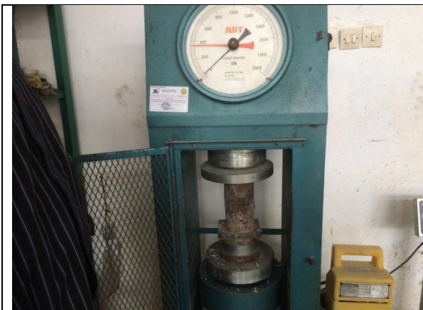
Pengujian Kuat Tekan Beton
