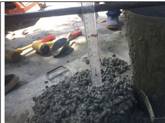
Pengujian Slump Setelah Menggunakan Superplasticizer
