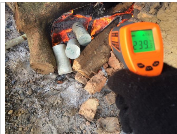
Proses Pembakaran Beton Suhu 200° C
