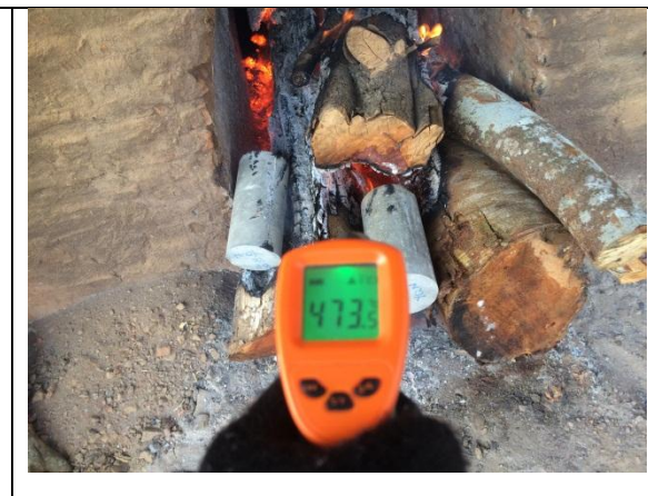
Proses Pembakaran Beton Suhu 400° C
