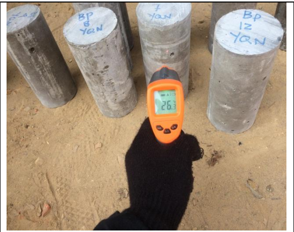
Pengecekan Suhu Beton Sebelum Dibakar
