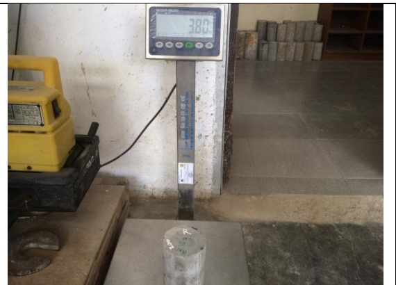
Penimbangan Beton Pasca Bakar Dengan Perendaman
