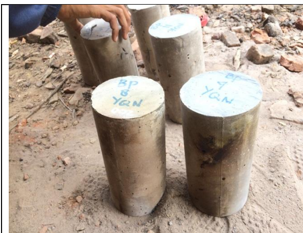
Beton Setelah Dibakar Dengan Suhu 200° C
