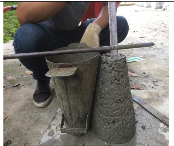
Pengujian Slump Sebelum Menggunakan Superplasticizer
