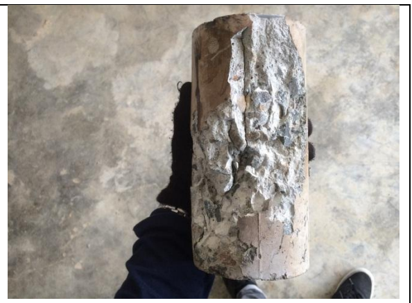
Pecahan Benda Uji Setelah Pengujian Kuat Tekan
