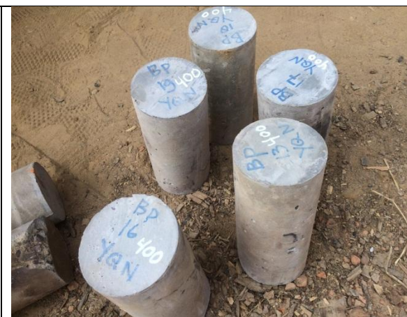
Beton Setelah Dibakar Dengan Suhu 400° C
