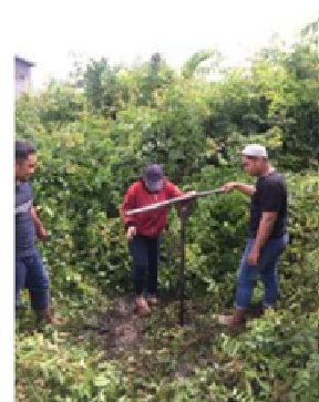
Gambar 2. Pengeboran dangkal menggunakan alat Uji Handbored untuk memperoleh sampel UDS
