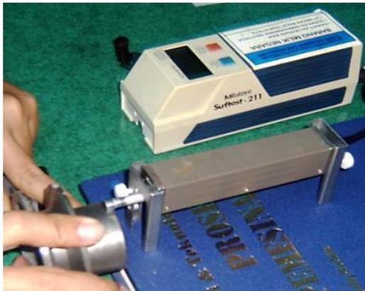
Gambar 7. Pengukuran Kekasaran Permukaan pada Produk dengan Surface Roughness Profilometer
