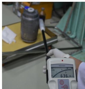
Gambar 3. Proses pengukuran laju dosis pada permukaan generator ^{99}\text{Mo}/^{99\text{m}}\text{Tc}
