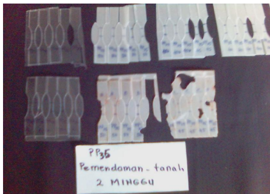
Gambar 8. Hasil soil butiral test nonkomposit PP35-CaCO 3 untuk 2 (dua) minggu dan 2 (dua) bulan dengan komposisi 40:60
