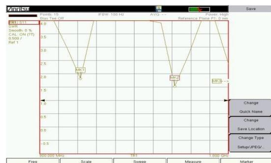
Gambar 4.7 Hasil Pengujian VSWR Antena Array
