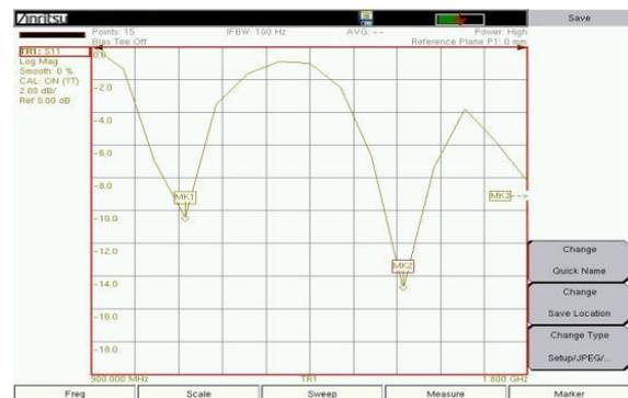
Gambar 4.6 Data Return loss Hasil Pengujian Antena
