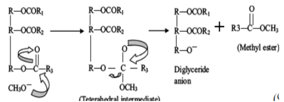
Gambar 4. Mekanisme Pembentukan Metil Ester (Biodiesel)
