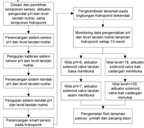
Gambar 1. Diagram alir penerapan smart sensor untuk kendali pH dan level larutan nutrisi
