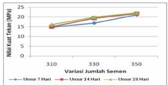
Gambar 6. Kurva Hubungan Variasi Jumlah Semen- Kuat Tekan Beton
