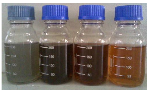
Gambar 1. Larutan Koloid Nanopartikel Perak Hasil Sintesis dengan Metode Reduksi \text{AgNO}_3 dengan Reduktor \text{NaBH}_4
