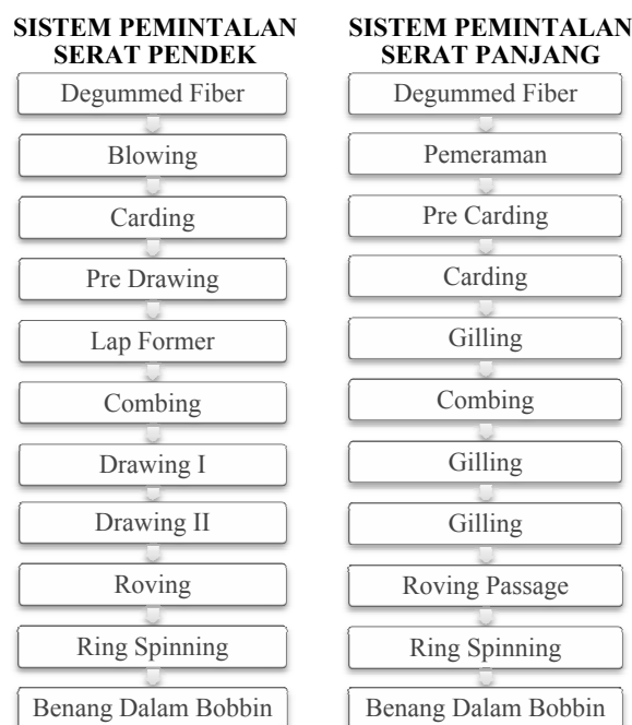
Gambar 6. Sistem pemintalan serat rami
