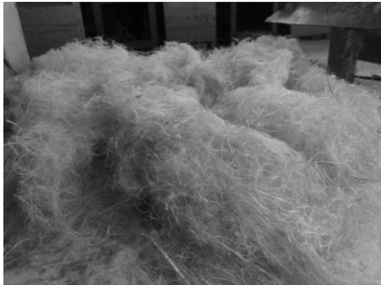
**Gambar 3.** Serat bambu tali (*Gigantochloa apus*) yang siap untuk dipintal dengan alat jantra.
