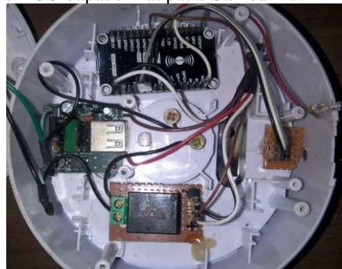
Gambar 27. Perangkat Kendali Lampu
