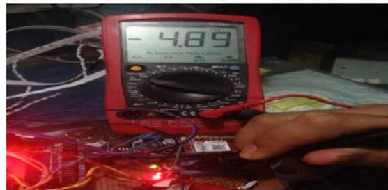
Gambar 12. Pengukuran *Relay* Pada Saat High
