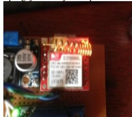
Gambar 1. Rangkaian pengujian *Sim800L*
