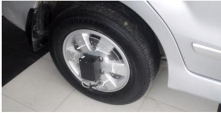
Gambar 18. Modul Sensor Pada Ban
