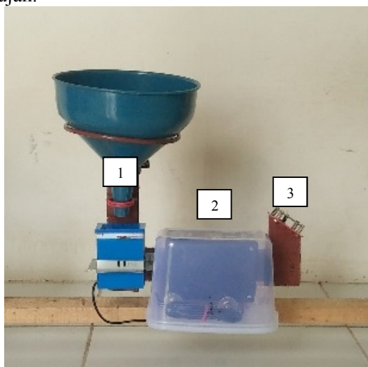
Gambar 10. Purwarupa alat deteksi hujan dan curah hujan
